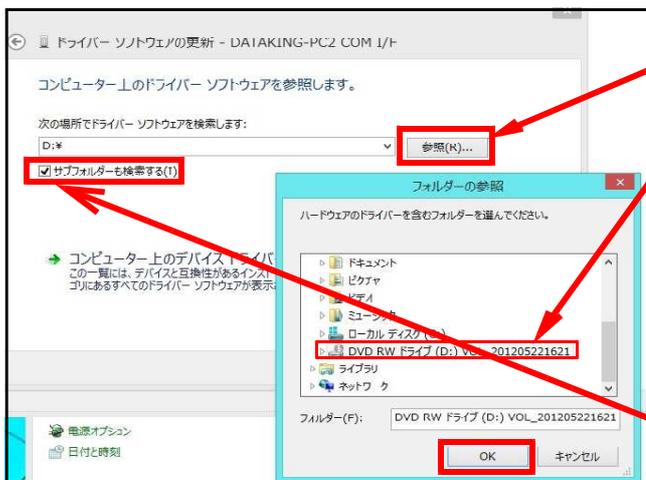
「参照」で、DATAKING - PC2 インストール CD をセットしたドライブを選びます。
